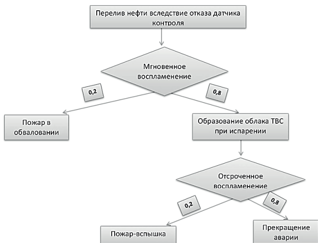
Рис. 1. Дерево событий аварийной ситуации при переливе нефти вследствие отказа датчика контроля уровня
